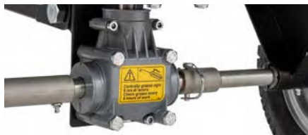
abschaltbares, robustes Getriebe mit Aluminiumgehäuse
