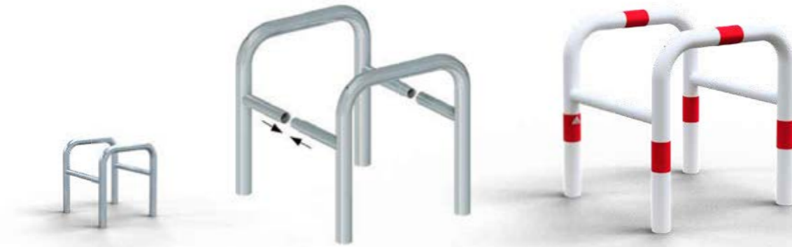
Baum und Säulenschutz Stahlrohrkonstruktion aus zwei Rundbügeln Ø 60 mm mit angeschweißten Querholm Ø 48 mm zum Ineinanderstecken
