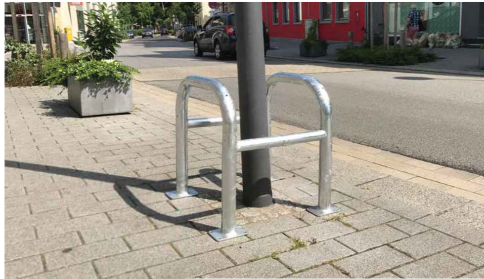
Baum und Säulenschutz Stahlrohrkonstruktion aus zwei Rundbügeln Ø 60 mm mit angeschweißten Querholm Ø 48 mm zum Ineinanderstecken
