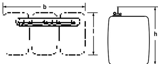
\*\*\* Die unterschiedl. Höhenmaße bei Batterieanlagen mit Tanks gleicher Baugröße hängen mit den unterschiedlichen Einbautiefen der Grenzwertgeber zusammen.
