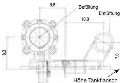
Anschlussmaße in cm für Befüll- und Entlüftungsleitung bei Batterieanlagen
