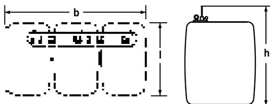
\*\*\* Die unterschiedl. Höhenmaße bei Batterieanlagen mit Tanks gleicher Baugröße hängen mit den unterschiedlichen Einbautiefen der Grenzwertgeber zusammen.
