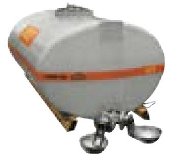
Speziell für den Einsatz auf Unimog-Fahrzeugen gibt es Fässer oval oder kofferförmig von 1000l–5000l, auch als Schnellläufer-Ausführung mit Schwallwänden.
