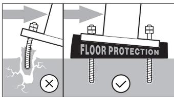
Die Standardausführung der Black Bull Rammenschutz-Bügel wird mit zusätzlichen Polyurethan-Federelementen ausgerüstet. Das UV-beständige und dauerelastische PU-Element absorbiert die auf den Bügel wirkenden Kräfte.
