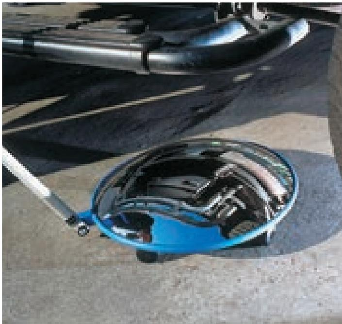
Sicherheitskontrollen an Fahrzeugunterseiten leicht und bequem durchführen.
