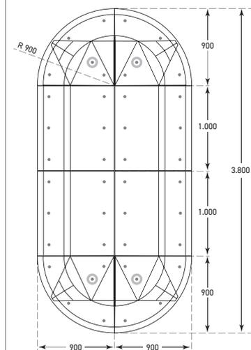
Ein Set besteht aus 6 bzw. 8 Elementen, die mittels H-Eisen leicht und sicher verbunden werden. Eine Demontage und Lagerung sowie eine spätere Wiederverwendung des Sets ist problemlos möglich. Das benötigte Befestigungs-zubehör ist im Lieferumfang enthalten.
