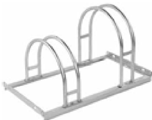
Der robuste Fahrradständer aus feuerverzinktem Stahl ist mit Rundrohr-Bügeln von 18 mm Durchmesser ausgestattet. Die hoch und tief gestellten Bügel ermöglichen eine platzsparende Nutzung. Er ist geeignet für Mountainbikes mit bis zu 64 mm Reifenbreite und Räder mit Scheibenbremsen. Der bogenförmige Bügel erlaubt sowohl ein- als auch zweiseitiges Parken der Räder. Bei einseitiger Radeinstellung beträgt die Stellraumtiefe etwa 1850 mm, bei zweiseitiger Radeinstellung etwa 3.200 mm.
