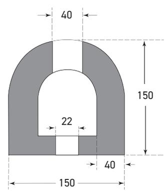
Dieses Schutzelement in hohler D-Form aus schwarzem Gummi mit Stahlverstärkung schützt zuverlässig vor Beschädigungen, absorbiert harte Stöße und bietet zuverlässigen Schutz auch unter hohen Belastungen.
