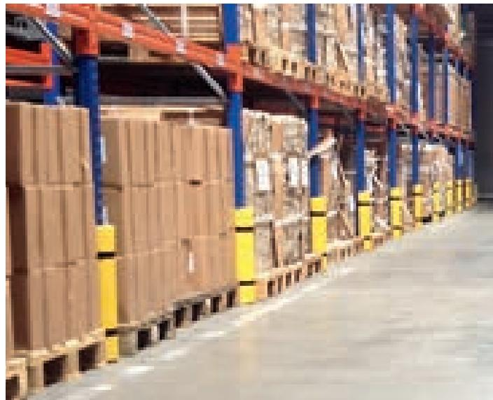
Anfahrerschutz-Element aus gelbem, hochwertigem Polyethylen (MDPE) zum Schutz von Regalstützen. Zusätzlich fixiert durch zwei Klettbänder – verhindert ungewolltes Verrutschen.
