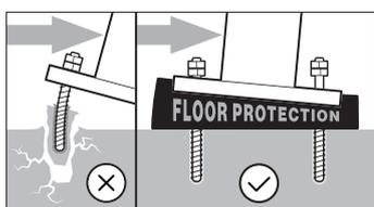
Flexible Rammschutz-Planke SWING: Die Standpfosten der BLACK BULL Rammschutz-Planke werden zusätzlich mit einem Polyurethan-Federelement ausgerüstet.
