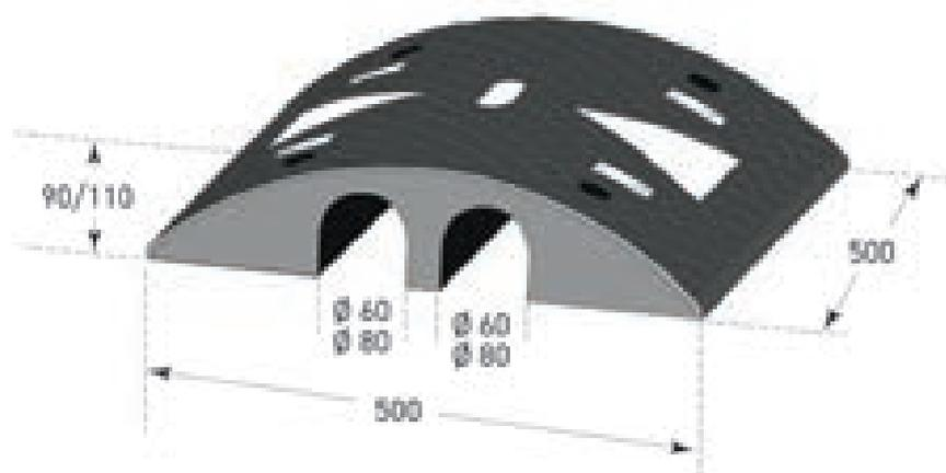
Speziell entwickelt für härteste Ansprüche schützt die LKW-Kabelbrücke effektiv Rohre, Schläuche oder Kabel vor Schäden durch Schwerlastfahrzeuge.
