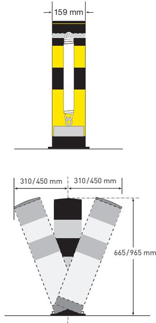
Die innenliegende Stahl-Spiralfeder absorbiert in Verbindung mit dem elastischen Puffer aus Polyurethan die auftretenden Anfahrkräfte (progressive Kraftaufnahme). Minimiert Beschädigungen am Poller und am Fahrzeug (Stapler, LKW). Schützt Roll- und Brandschutzstore, Übergänge an Fahrwegen, Rampen, Zufahrten. Der flexible Poller aus Gütestahl neigt sich bis max. 25° (ca. 310 mm) und stellt sich automatisch in die Ausgangsposition zurück.
