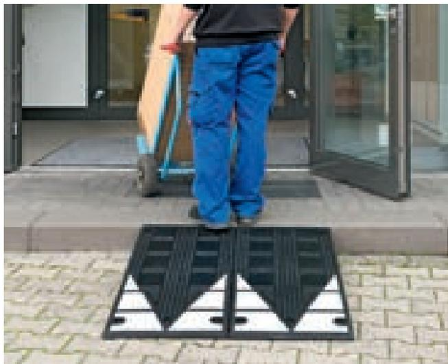
Bordstein-Rampe aus vulkanisiertem Kautschuk, schwarz durchgefärbt mit weiß reflektierenden Flächen. Keine Montage nötig. Sicher durch hohes Eigengewicht. Zusätzliches Verdübeln möglich.
