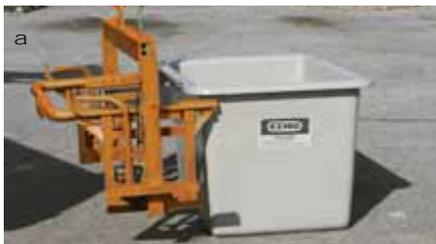
Einfahren des Ladebügels von der Seite nach dem Entfernen des abnehmbaren Deckels (Beispiel mit Streugutbehälter 700l)
