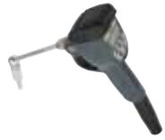
Ölabgabepistole K500,<br>mit elektronischem Zähler, Anschluss mit Drehgelenk ½" IG,<br>2-fach abwinkelbarer Auslass mit Antitropf-Mundstück,<br>1–30 l/min, max. 70 bar, mit Mengeneinstellung<br>von 0,1–99,9 l. Ist die voreingestellte Menge erreicht,<br>schließt die Pistole automatisch. | 8576      | 810,-      |
