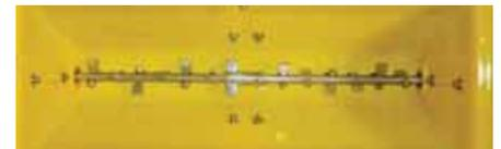
robuste Rührwelle, Achse mittig geteilt, einstellbare Rührflügel
