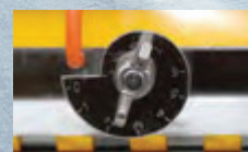
robuste Rührwelle, Achse mittig geteilt, einstellbare Rührflügel
