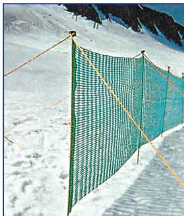
Schneefangzaun aus verrottungsfestem Polyethylen-Gewirke mit eingearbeiteten biegeelastischen glasfaserverstärkten Polyester-Aufstellstäben. Stab mit Abdeckkappe aus Polyamid und 2 Ösen zur Befestigung der Abspannseile. Aufgrund der besonderen Maschenöffnung findet eine optimale Schneeverwirbelung statt.
