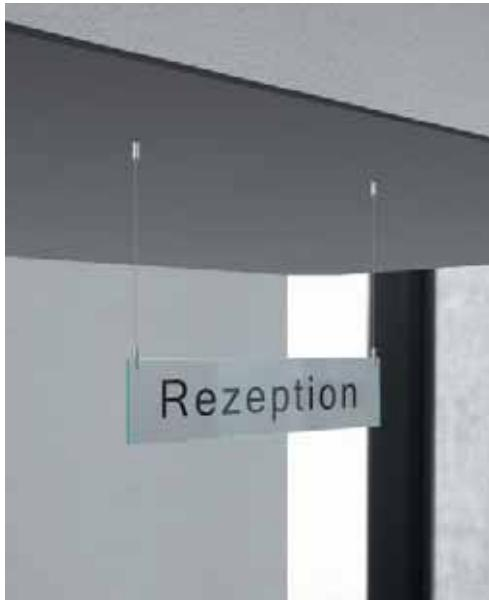
Das Grundmodell „Deckenmontage“ besteht aus je 2 Deckenstücken und Schilderbefestigungen, 2 x 1000 mm Edelstahlseil sowie - je nach Ausführung - 1 bzw. 2 Glasscheiben (thermisch gehärtet, 5 mm stark) im gewählten Format. Diese weisen zwei bzw. vier Bohrungen auf, je nachdem, ob eine Erweiterungsscheibe gewählt wird oder nicht.
