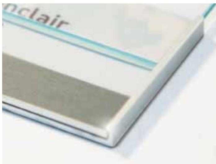
Die sehr flache Bauweise von nur 7 mm ist nur ein Merkmal der SmartFix Schilderserie. Das 3-teilige Schild besteht aus einem Aluminiumprofil Silber eloxiert mit seitlichen Führungsschienen, einer 3mm starken Abdeckung aus thermisch gehärtetem Glas und einer dünnen Einlage aus Aluminium gebürstet mit einer Z-Falz am oberen und unteren Rand. Diese hält die Glasabdeckung und macht den Einlegerwechsel sehr einfach und schnell.
