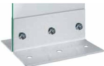
Die Winkel für die unterflurmontierten Außenstelen werden aus 10 mm starken feuerverzinkten Stahl gefertigt. Die Winkel besitzen jeweils am vertikalen und horizontalen Schenkel je nach Breite 3 oder mehr Lochbohrungen (Ø 20 mm/14 mm). Die Verbindung erfolgt mit Gewindestangen und Hutmuttern aus Edelstahl.
