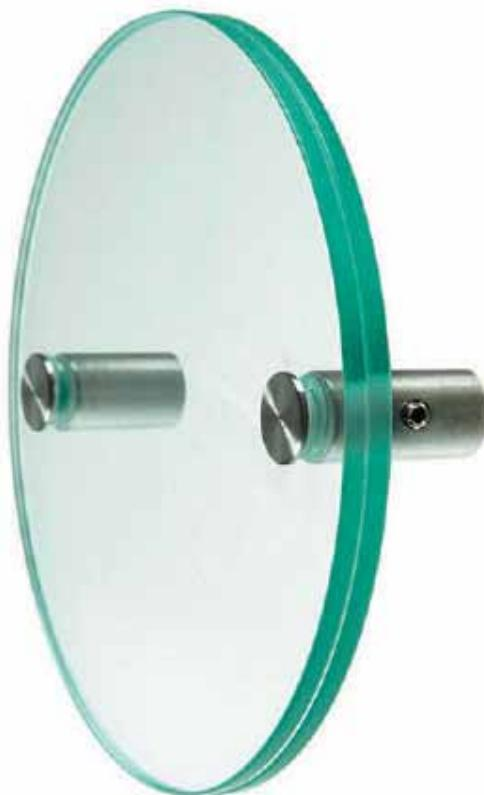
Warum nicht einmal rund? Das PremiumFix Schild gibt es jetzt auch in zwei runden Ausführungen, Ø 120 mm und Ø 200 mm. Beide Varianten bestehen aus 2 thermisch gehärteten Glasscheiben (4 mm stark) und 2 Edelstahl-Abstandshaltern, Ø 13 mm bei der kleiner und Ø 18 mm bei der größeren Variante. Auch zu diesem System gibt es die passenden Beschriftungseinleger, die im letzten Kapitel „Zubehör, Folien & Beschriftungseinleger“ angeboten werden.
