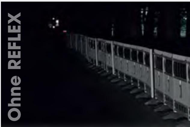
Bei flachem Anstrahlwinkel reflektieren die Absperrschrankengitter das Scheinwerferlicht nur unzureichend.
