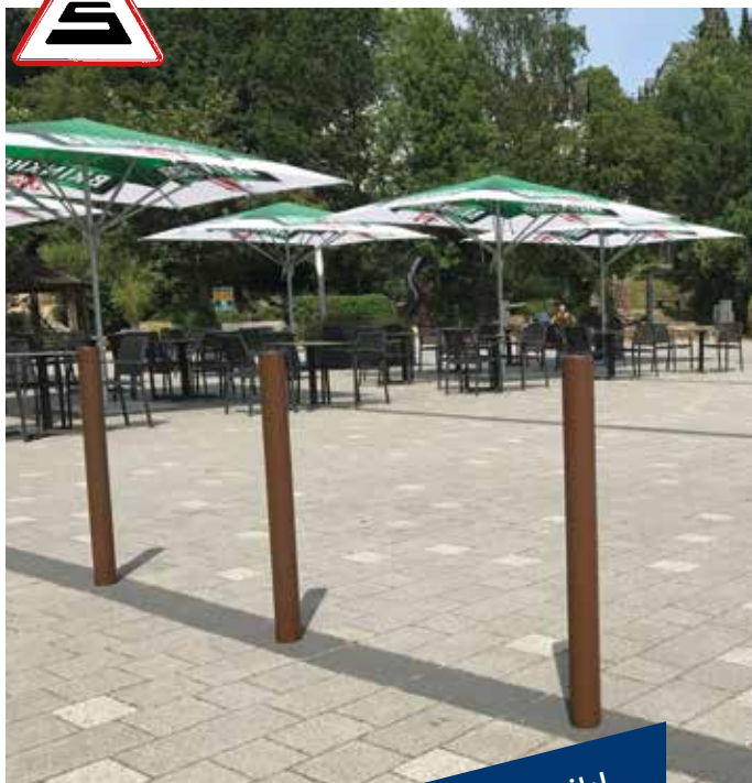
Absperr-Stilpfosten aus Stahlrohr Ø 76 mm ca. 900 mm Überflur, feuerverzinkt und beschichtet
