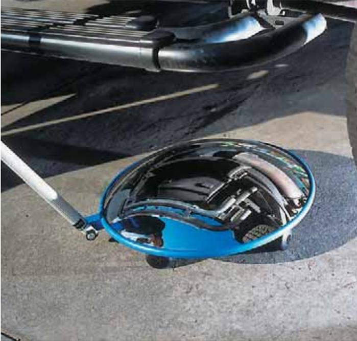
Sicherheitskontrollen an Fahrzeugunterseiten leicht und bequem durchführen.
