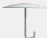
**Stahlkappe mit Betonanker**
